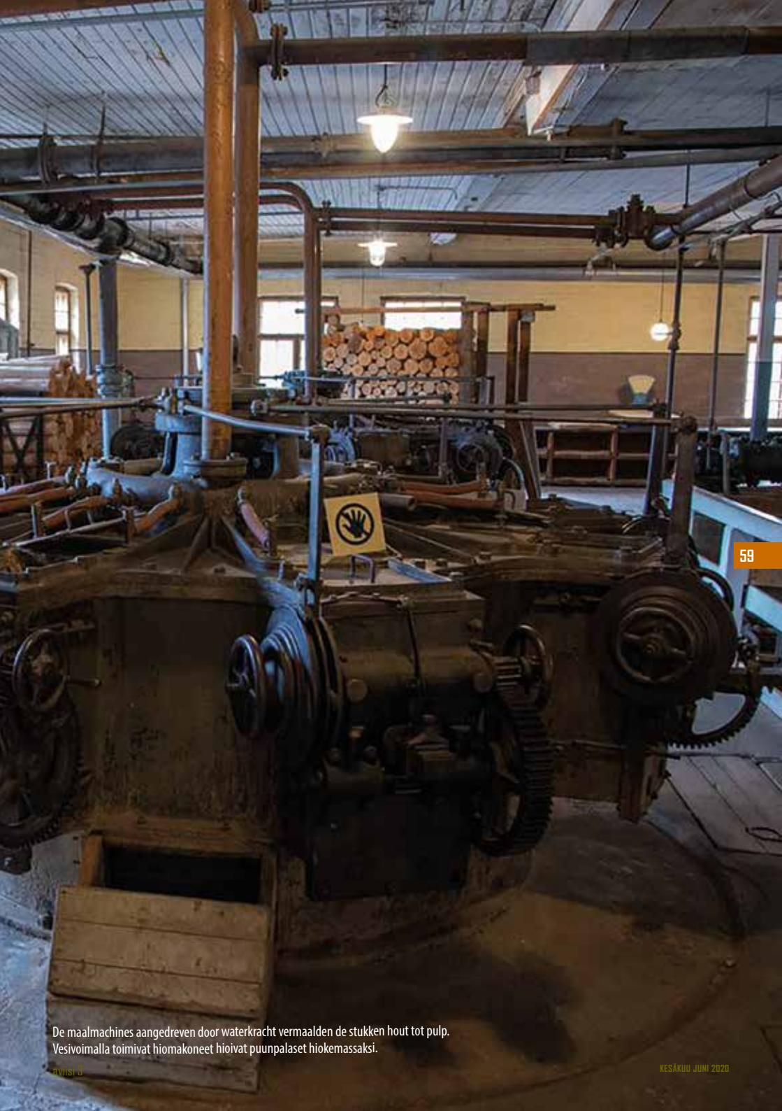
De maalmachines aangedreven door waterkracht vermaalden de stukken hout tot pulp.
